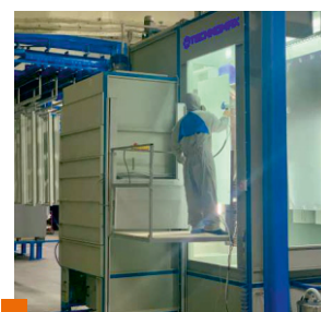
Атмосферостойкая порошковая краска и обезжиривание фосфатирующим составом Повышенная антикоррозионная стойкость
